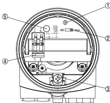
Отсек электроники и подключения - бесконтактный переключатель
