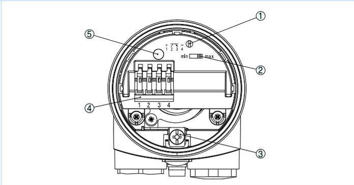
Отсек электроники и подключения - транзисторный выход
