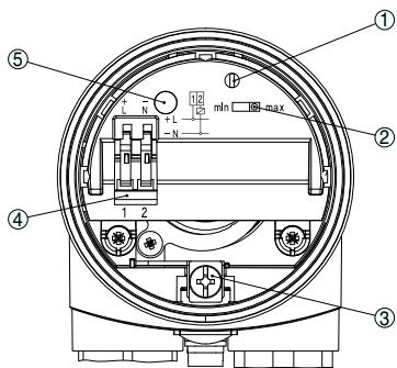
Отсек электроники и подключения - бесконтактный переключатель
