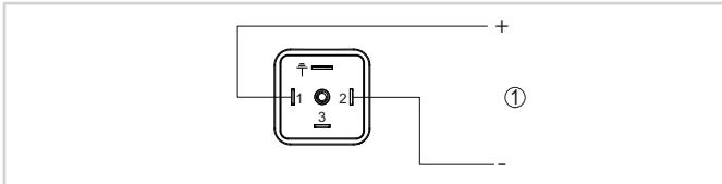
Схема подключения - 2-провод. 4 ... 20 mA - штекер по ISO 4400
