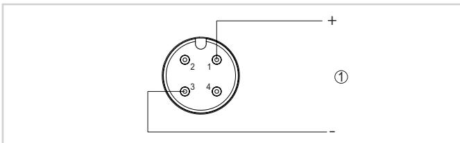
Схема подключения - 2-провод. 4 ... 20 mA - штекер M12 x 1
