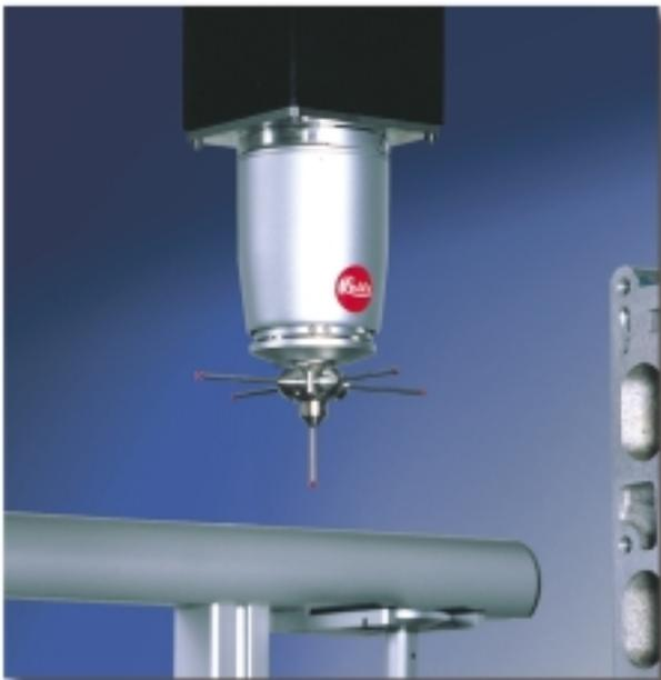
Поддержка технологии сверхвысокоточного контактного измерения
