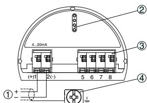
Отсек электроники и подключения в однокамерном корпусе
