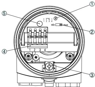
Отсек электроники и подключения - транзисторный выход
