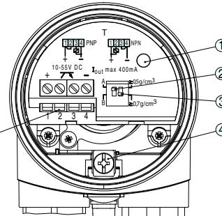
Отсек электроники и подключения - однокамерный корпус
