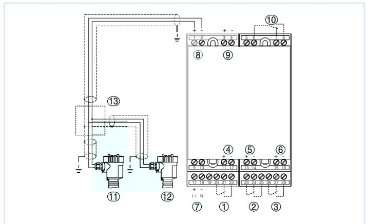
Подключение VEGAMET 625 и двухпроводных датчиков
