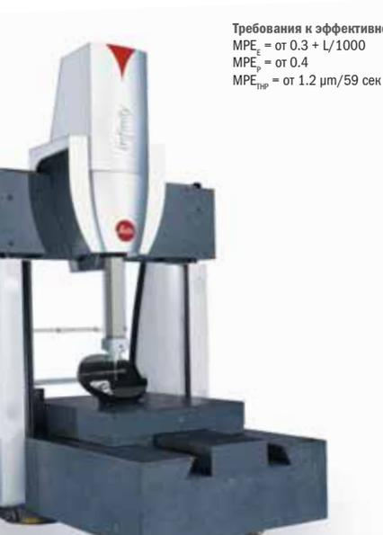
**Leitz REFERENCE** – КИМ мостового типа с подвижным порталом – идеальная машина в своем классе, способная выполнять сложные измерительные задачи, сочетая высокую точность с максимальной производительностью. Машина выпускается в различных размерах, гарантирует быстроту, точность и экономичность исследования рабочих деталей.
