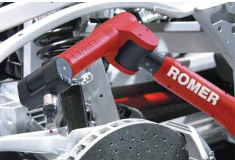
**ROMER** – создатель портативной измерительной руки, которая впервые появилась в 1986 году в Монтуре, Франция. Технологический прогресс, ноу-хау, требование неизменного качества в производстве рук, международное присутствие являются сильными сторонами компании ROMER. ROMER также является производителем сканирующих датчиков для инженерного анализа, бесконтактных датчиков для исследования труб и обработки сырья.
