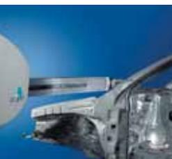
**TORO** – инновационная линия автоматических измерительных машин с горизонтальной рукой для обследования размеров элементов из тонколистового материала и крупных деталей. TORO отличается необычным соотношением цена/ качество, с закрепленными на полу направляющими.
