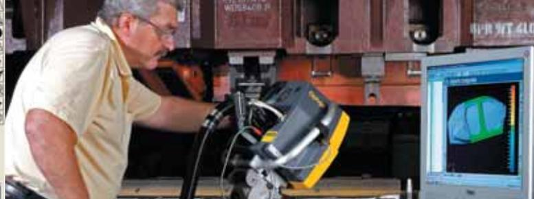
Пакет программного обеспечения для линейных измерений CogniTens представляет совокупность программных продуктов, которые при совмещении с измерительными платформами CogniTens Optigo и OptiCell, функционируют наиболее эффективно. Данный программный пакет в сочетании с инновационной коммерческой деятельностью дает возможность производителям перейти от традиционных методов работы дорогостоящих контрольных устройств и других технологий к бесконтактному измерительному процессу.
