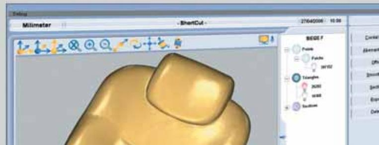
Пакет программного обеспечения **ROMER** представляет собой полный набор инструментов для решения нескольких метрологических задач: геометрическое и поверхностное обследование, сканирование и обследование труб. Программы специально разработаны для портативных измерительных рук 3D и предназначены для запуска на стандартном ПК оборудовании. Благодаря удобству программ пользователю потребуется всего лишь 2-4 дня тренировки для ознакомления с ними. Пакет ПО включает в себя:
