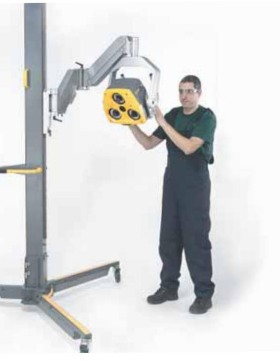
**OptiCell** – полностью автоматизированная измерительная платформа со встроенным программным обеспечением, которое значительно улучшает процесс измерений в автомобильной промышленности при производстве запчастей для автомобилей и процессе сборки.
